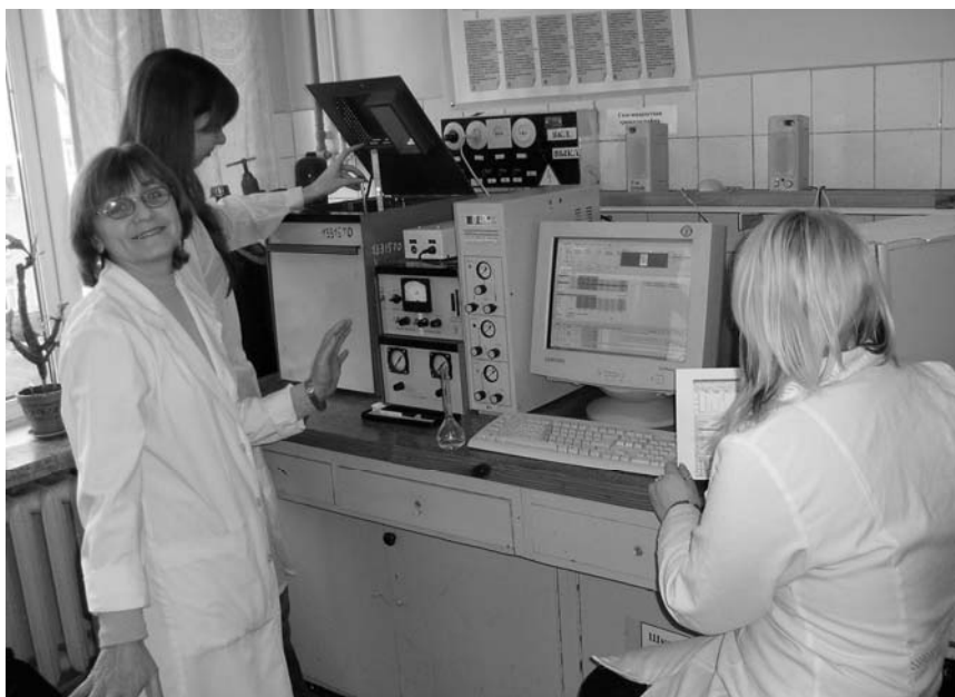
Рис. 2. В учебной лаборатории кафедры аналитической химии БГТУ: выполнение лабораторной работы с использованием комплекса хроматограф – внешний модуль ADC L-net – ПК и современного программного обеспечения UniChrom
