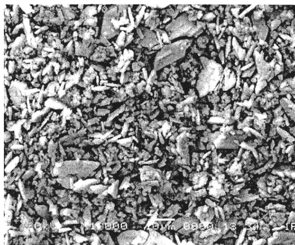
Рис. 2. Микрофотография образца 2, полученного в системе \text{Al}_2(\text{SO}_4)_3\text{--CaCO}_3\text{--NaOH--Na}_2\text{CO}_3\text{--H}_2\text{O}
