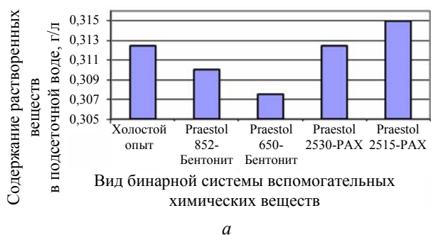
Рис. 2. Содержание взвешенных веществ в подсеточной воде: а – целлюлоза сульфитная хвойная беленая; б – целлюлоза сульфитная лиственная беленая; в – целлюлоза сульфатная хвойная беленая; г – термомеханическая древесная масса
