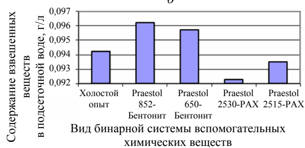
Рис. 2. Содержание взвешенных веществ в подсеточной воде: а – целлюлоза сульфитная хвойная беленая; б – целлюлоза сульфитная лиственная беленая; в – целлюлоза сульфатная хвойная беленая; г – термомеханическая древесная масса
