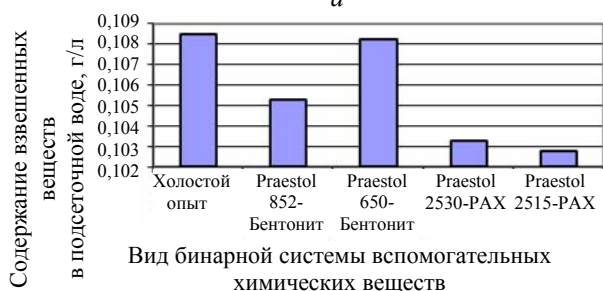
Рис. 2. Содержание взвешенных веществ в подсеточной воде: а – целлюлоза сульфитная хвойная беленая; б – целлюлоза сульфитная лиственная беленая; в – целлюлоза сульфатная хвойная беленая; г – термомеханическая древесная масса
