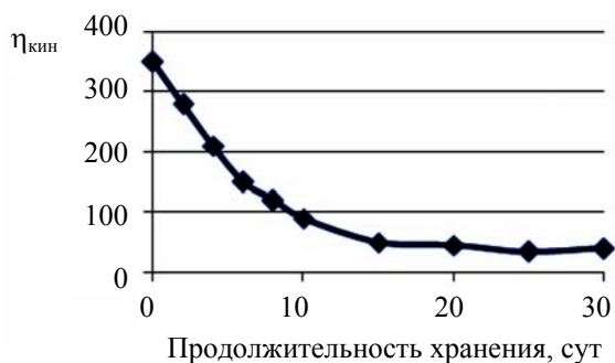
Рис. 1. Изменение кинематической вязкости полиимидных композиций в зависимости от продолжительности хранения при 20°C
