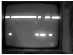
Рис. 6. Осциллограмма данных на выходе фотоприемника однолучевого светового барьера
