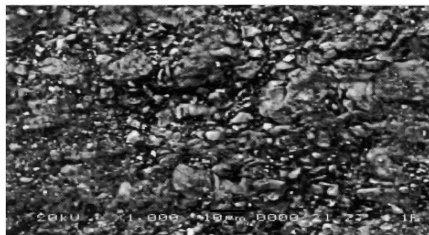
Рис. 1. Электронная микрофотография поверхности образца \text{Na}_{0,90}\text{CoO}_2 , спеченного при 1203 К
