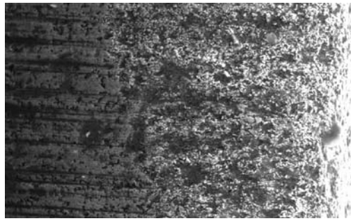
Рис. 3. Изображение поверхности режущей кромки инструмента без покрытия после деревообработки (РЭМ)
