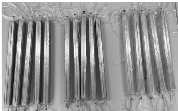
Рис. 3. Фиксирование нитей стекловолокна на образцах
