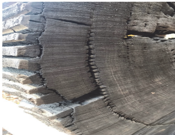
Рис. 4. Последствия неправильного режима сушки
