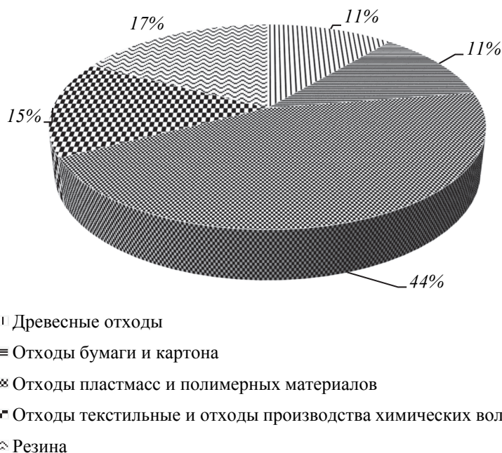
Рис. 1. Состав RDF-топлива из ТКО
