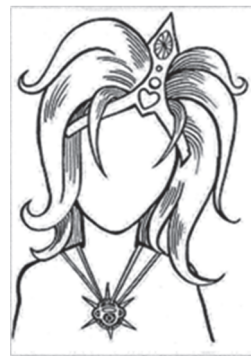
Рис. 3. Ризографический оттиск изображения типа «контурный рисунок», полученный периодическим способом растривания
