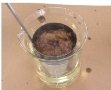
Рис. 4. Извлечение пропитанного углеводородной жидкостью ВОПР
