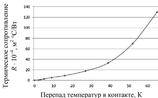
Рис. 4. Зависимость термического сопротивления от перепада температур в контакте
