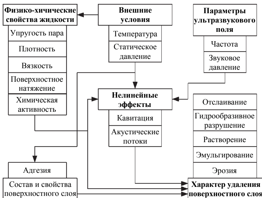
Рис. 2. Факторы, определяющие характер удаления загрязнений в УЗ-поле
