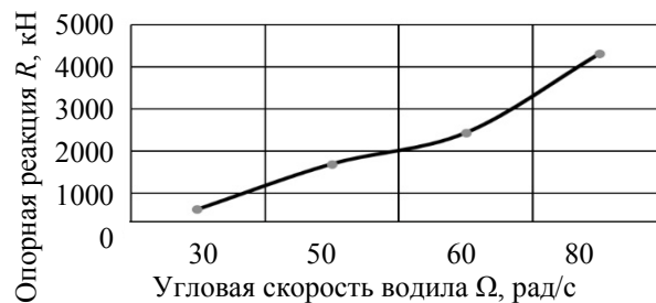
Рис. 3. Зависимость изменения величины опорной реакции от угловой скорости водила
