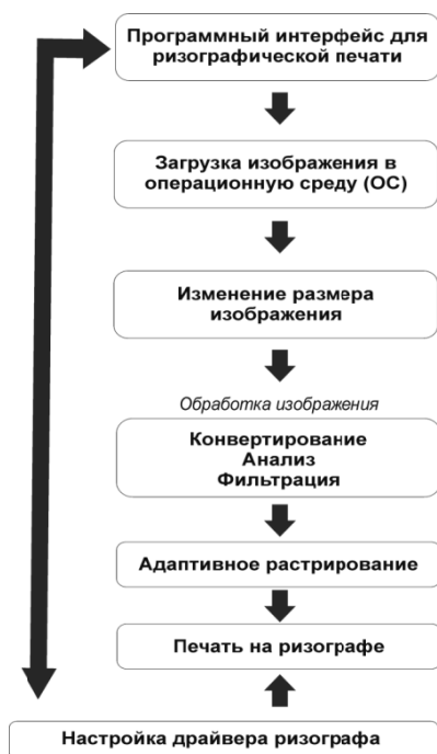
Рис. 2. Функциональная схема модуля управления качеством ризографической печати
