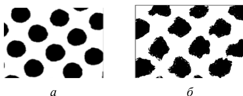
Рис. 5. Вид растровых точек 50%-ного заполнения черным цветом: а — эталон; б — печать на ризографе
