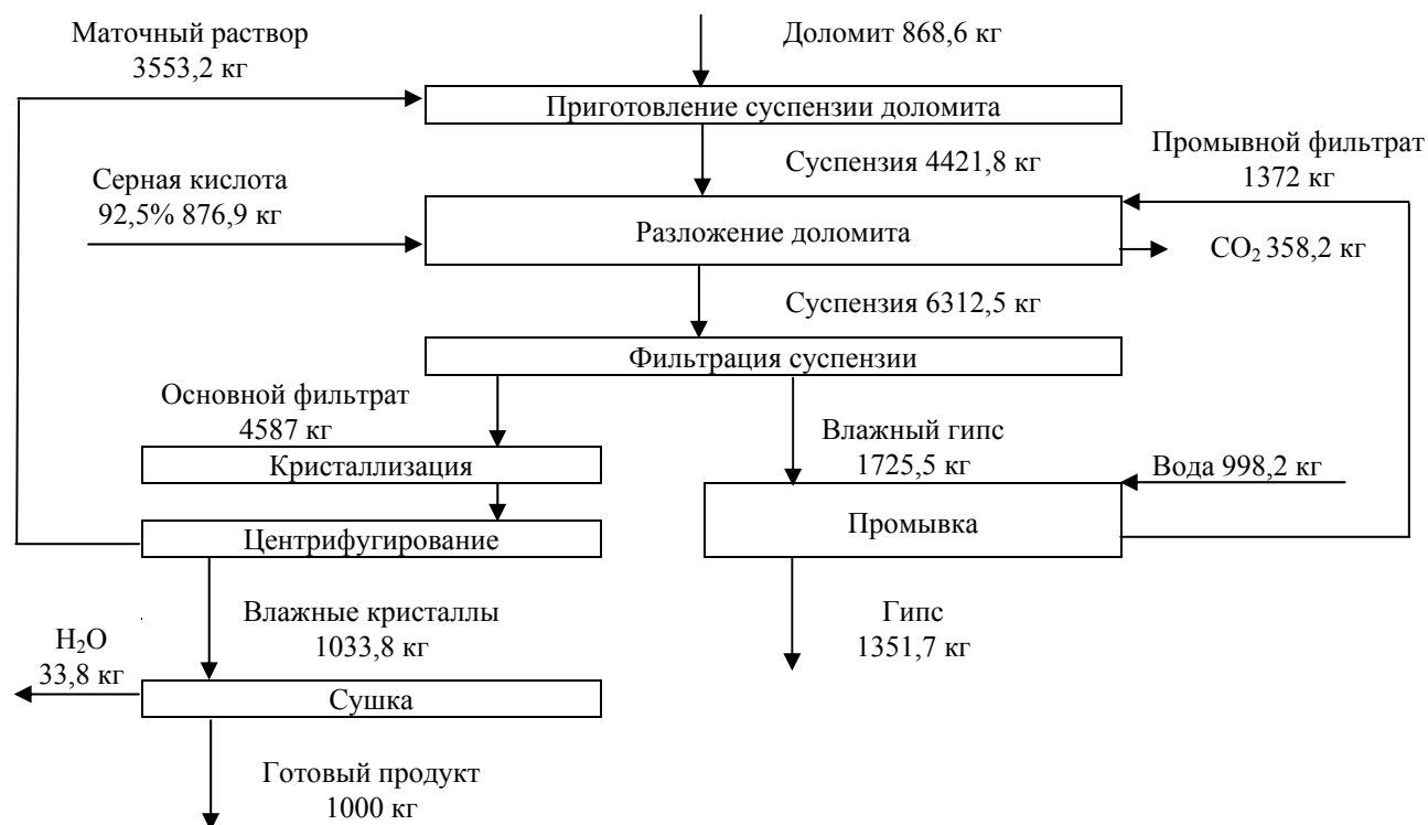
Рис. 3. Схема материальных потоков получения сульфата магния на 1 т \text{MgSO}_4 \cdot 7\text{H}_2\text{O}
