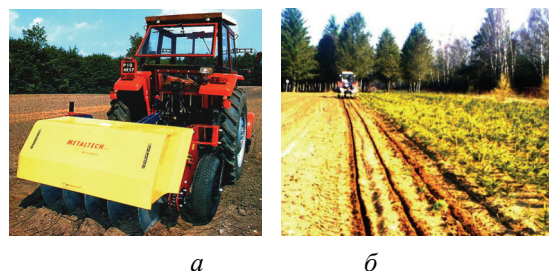
Рис. 3. Образование щелей для посадки: а – дисковым щелевателем; б – школьной сажалкой ЭМИ-5 (трехрядный вариант)
