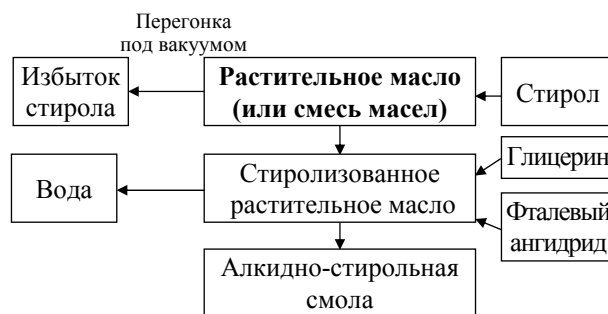
Рис. 4. Схема получения алкидно-стирольной смолы по методу 2
