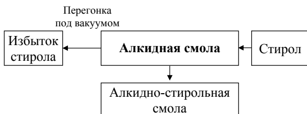
Рис. 6. Схема получения алкидно-стирольной смолы по методу 4
