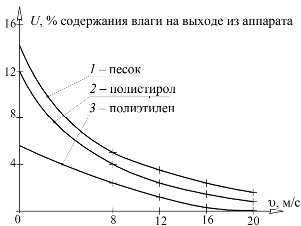
Рис. 3. График зависимости содержания влаги в материале на выходе из аппарата от среднерасходной скорости газа
