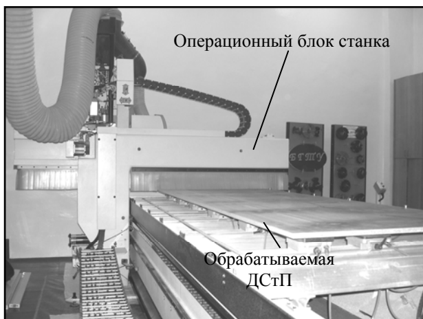
Рис. 1. Деревообрабатывающий центр ROVER B4.35 с ЧПУ с закрепленной на рабочем столе станка заготовкой ДСтП
