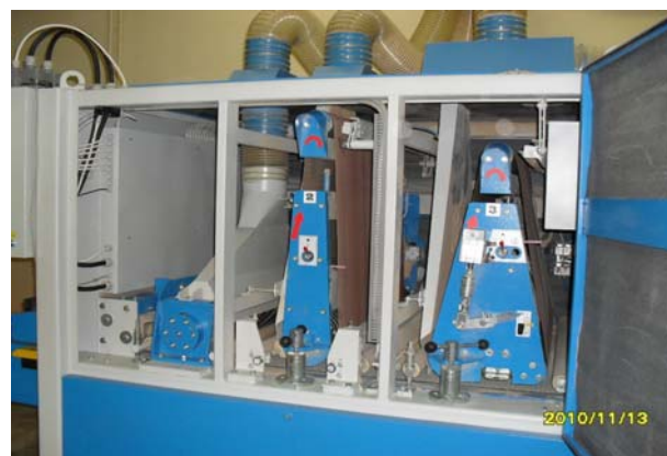
Рис. 2. Базовая конфигурация калибровально-шлифовального узла
