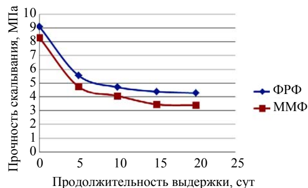
Рис. 2. Влияние воздействия воды на прочность клеевого соединения
