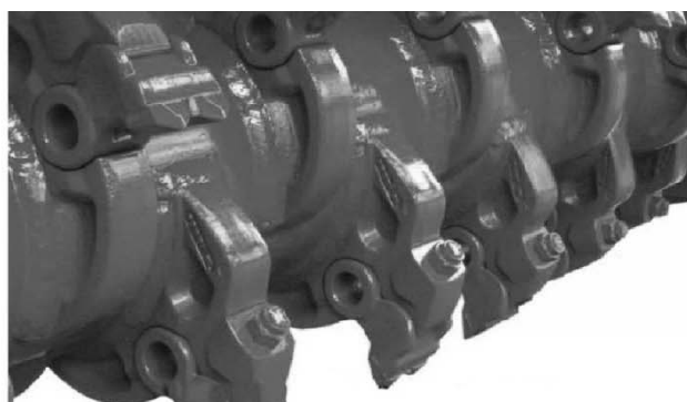
Рис. 3. Ротор мульчера с резами:
