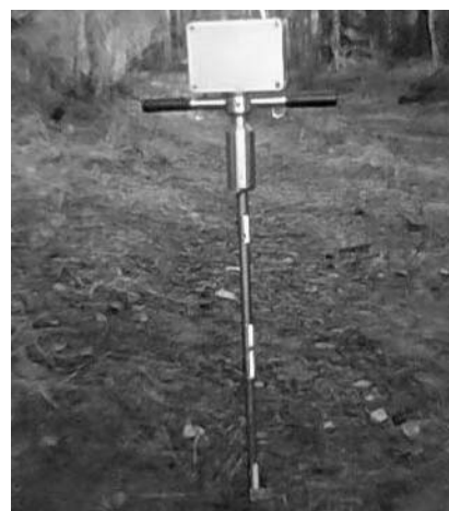
Рис. 6. Общий вид пенетromетра ПГ-3М
