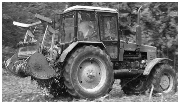
Рис. 1. Мульчер, установленный на шасси трактора МТЗ 1221В.2
