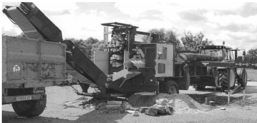
Рис. 2. Мобильная система машин для производства дров
