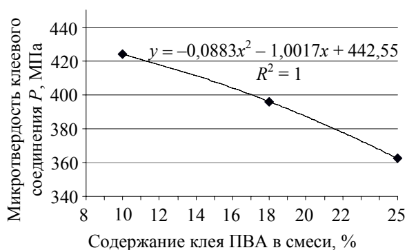
Рис. 4. Влияние содержания ПВА в клеевой композиции на прочность склеивания
