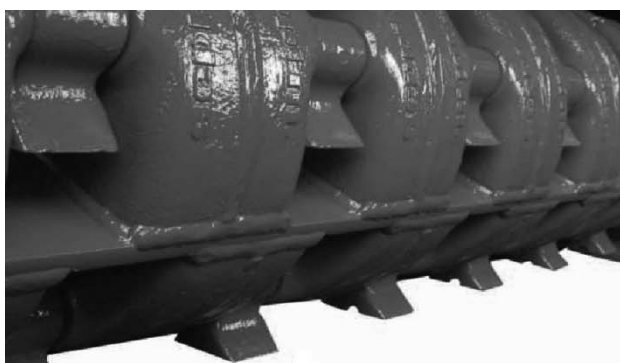
Рис. 3. Ротор мульчера с резами:
