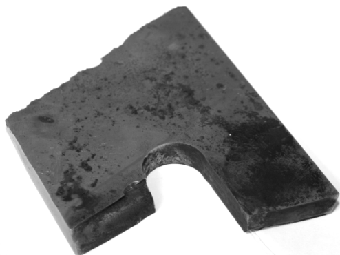
Рис. 2. Характер разрушения ножа
