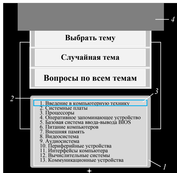
Рис. 3. Реализация главной страницы модуля тестирования: 1 – фон меню; 2 – текстовое поле, содержащее названия глав; 3 – экземпляр прозрачной управляющей кнопки, служащей для регистрации строки при нажатии мыши; 4 – масочный слой (при нажатии на кнопку «Выбрать тему» этот слой плавно спускается вниз и проявляет меню)
