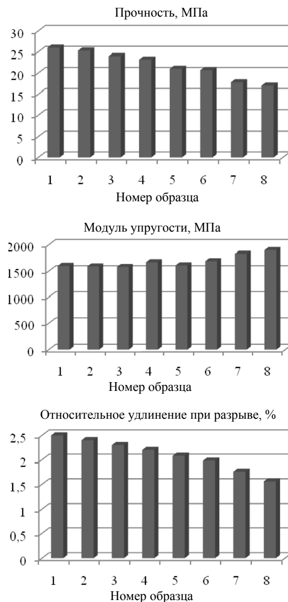
Рис. 1. Деформационно-прочностные и упругие свойства пленок из порошковых красок
