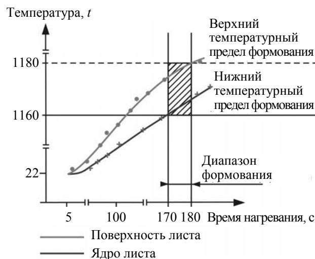
Рис. 2. Зависимость изменения температуры поверхности и середины композитного листа в процессе нагревания
