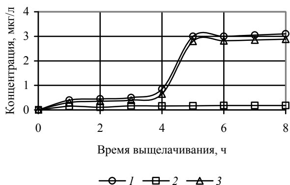
Рис. 4. Кинетика экстрагирования \text{Fe}^{3+} из кирпича в различных средах: 1 – кирпич с 20 мас. % осадка сточных вод гальванического производства ОАО «БелВАР» (pH = 4); 2 – кирпич с 20 мас. % осадка сточных вод гальванического производства ОАО «БелВАР» (pH = 10); 3 – кирпич без осадка (pH = 4)
