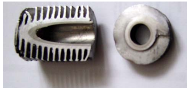
Рис. 2. Образец промышленной теплообменной поверхности
