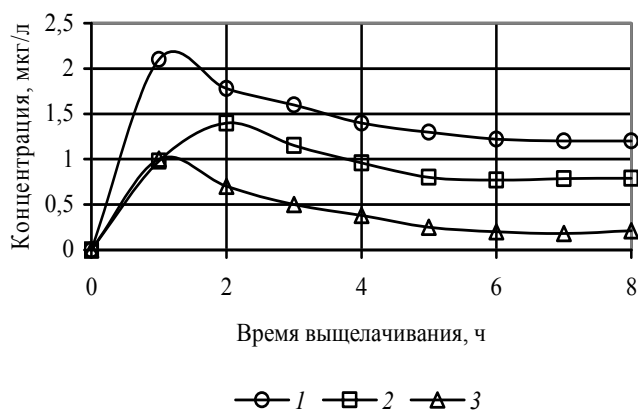
Рис. 3. Кинетика выщелачивания \text{Zn}^{2+} из кирпича в различных средах: 1 – кирпич с 20 мас. % осадка сточных вод гальванического производства ОАО «БелВАР» (pH = 4); 2 – кирпич с 20 мас. % осадка сточных вод гальванического производства ОАО «БелВАР» (pH = 7); 3 – кирпич без осадка (pH = 4)
